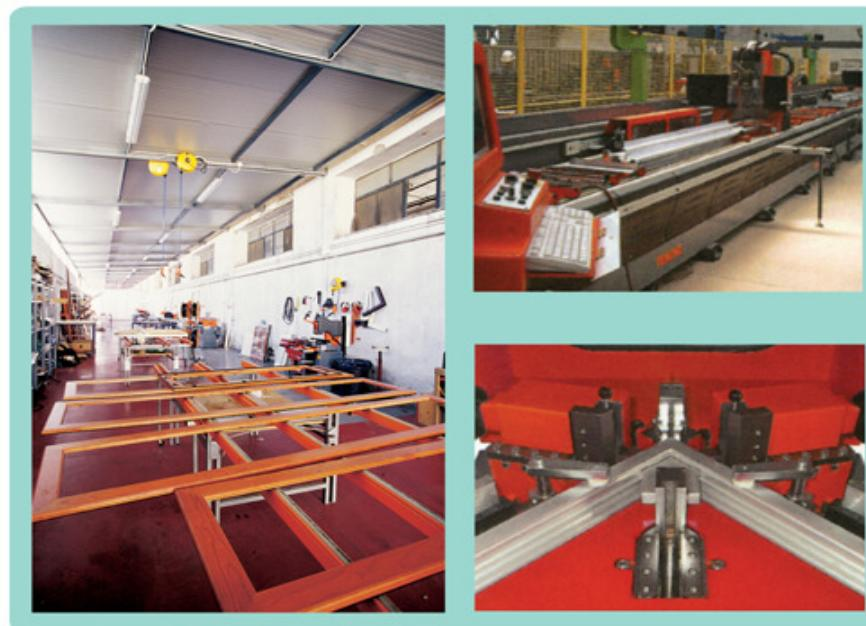
本公司採用歐洲精密的鋁木加工機器並運用義大利NOVAL SYSTEM原廠的設計及其原材料，讓鋁木的結合用旋卡式(*spin card*)方式製作，以因應鋁木的不同物性，使兩種異質性的素材緊密結合，又皆擁有自由伸縮的空間進而延長產品壽命。
